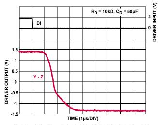
FIGURE 13. ISL32614E DRIVER WAVEFORMS, HIGH-TO-LOW
