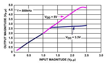
FIGURE 9. MAXIMUM OUTPUT MAGNITUDE vs INPUT MAGNITUDE
