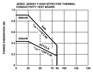
FIGURE 25. PACKAGE POWER DISSIPATION VS AMBIENT TEMPERATURE
