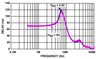
FIGURE 5. GROUP DELAY vs FREQUENCY
