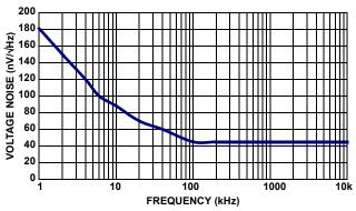
FIGURE 21. OUTPUT VOLTAGE NOISE vs FREQUENCY
