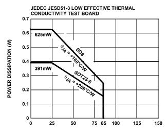
FIGURE 26. PACKAGE POWER DISSIPATION VS AMBIENT TEMPERATURE
