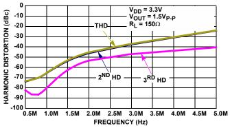
FIGURE 19. HARMONIC DISTORTION vs FREQUENCY
