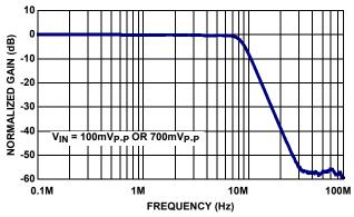
FIGURE 3. BANDWIDTH vs FREQUENCY
