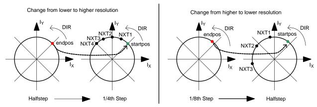
Figure 10. NXT-Step-Mode Synchronization
